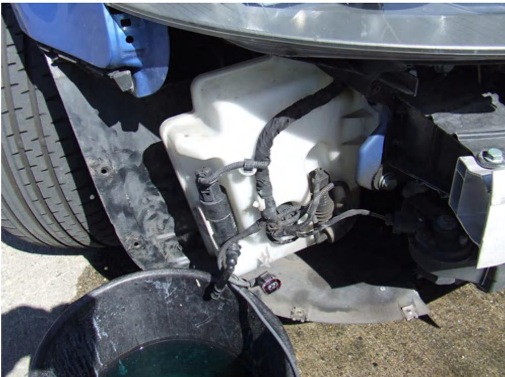
Jetzt das Reparaturkabel mit dem H11 Steckergehäuse anbauen.
