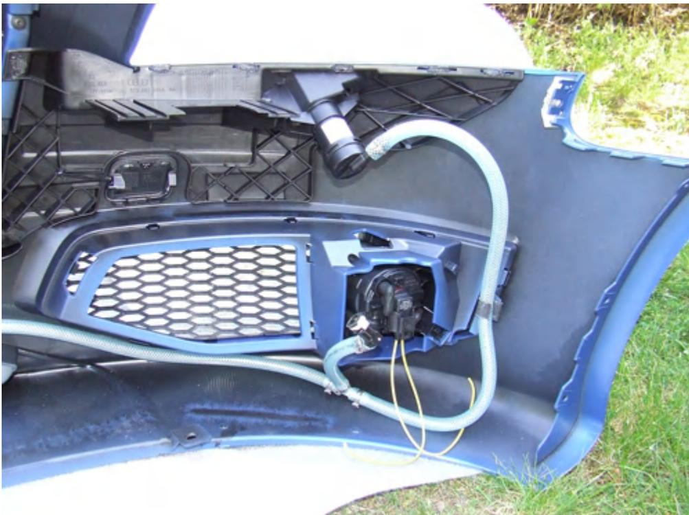
Den S3 Grill vorsichtig von unten nach oben in die Rastfedern einklicken und mit Torxschrauben befestigen. Somit ist die Frontschürze für den Anbau vorbereitet!
