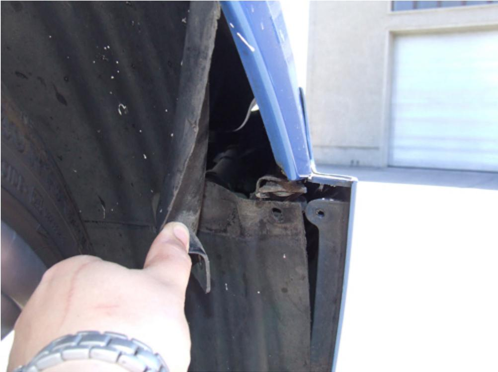
Dann den Innenkotflügel zur Seite drücken und diese Schraube entfernen.
