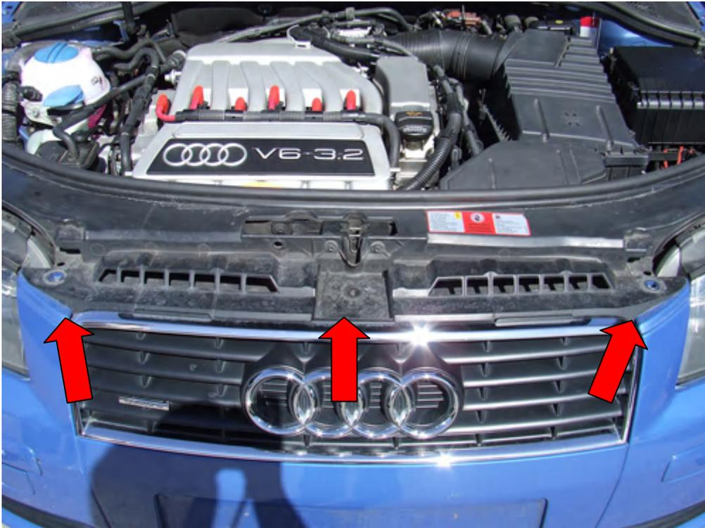
Dann einmal unter´s Auto. Die Schrauben entfernen die den Stoßfänger mit der Geräuschdämmung verbinden. Außerdem sind noch 3 zusätzliche Schrauben befestigt (Verlängerung Grill) die raus müssen. Insgesamt ca 10 an der Zahl.
