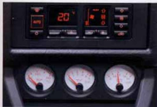
*Die Analog-Anzeigen für Öltemperatur, Öldruck und Bordspannung in der Mittelkonsole.*
