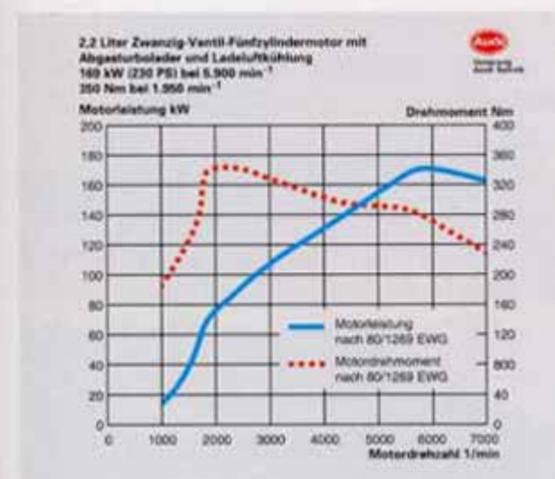
Die Leistungen des 169-kW-Motors mit Overboost-Funktion.
